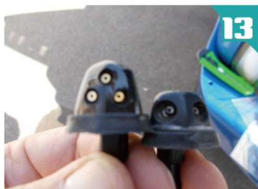
⑬新旧のノズルです。左が新しいノズル、右が古いノズルです。噴出孔の数が違います。
