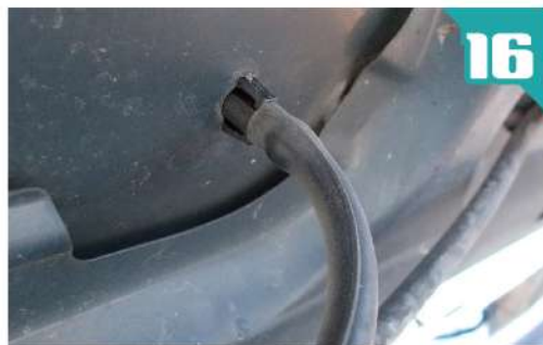
⑯ノズルにチューブを差し込みます。
