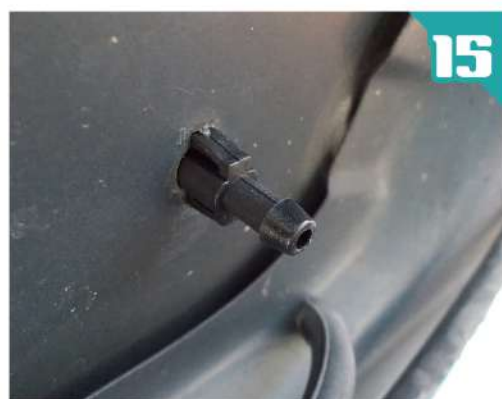
⑮ノズルの裏側のストッパーが完全にかかると同時に、向きを間違えないように注意しましょう。
