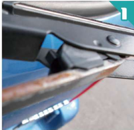
①ちょっと呆けていますがこれはワイパーです。アームとブレードの接続ポイントです。写真中央より少し右に四角い部分があるのがわかるでしょうか。これを手前に引っ張りながらブレードを引っ張ると…
