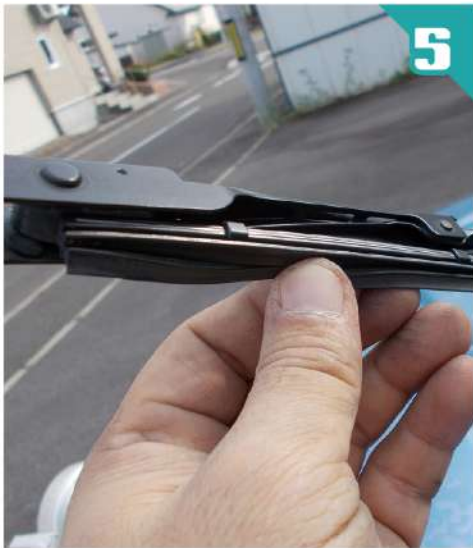
⑤④の反対側からブレードの枠に通していきます。
