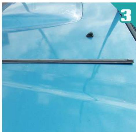
③ワイパーゴムを取り替えます。カー用品店などで幅と長さを確認して購入して下さい。
